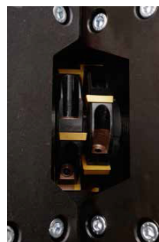
2 frese porta inserti complete di 6 inserti ciascuno
