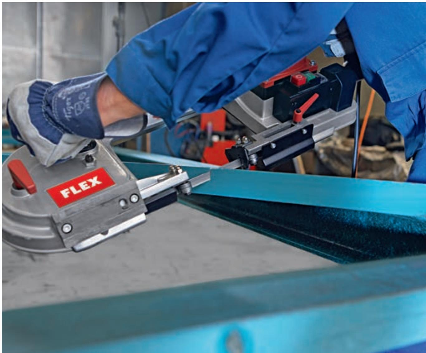
L'impugnatura ergonomica garantisce una guida sicura eseguendo lavori statici e a mano libera. La SBG 4910 è dotata di un sistema di serraggio di sicurezza a coda di rondine che permette di fissarla al banco e di trasportarla facilmente.
