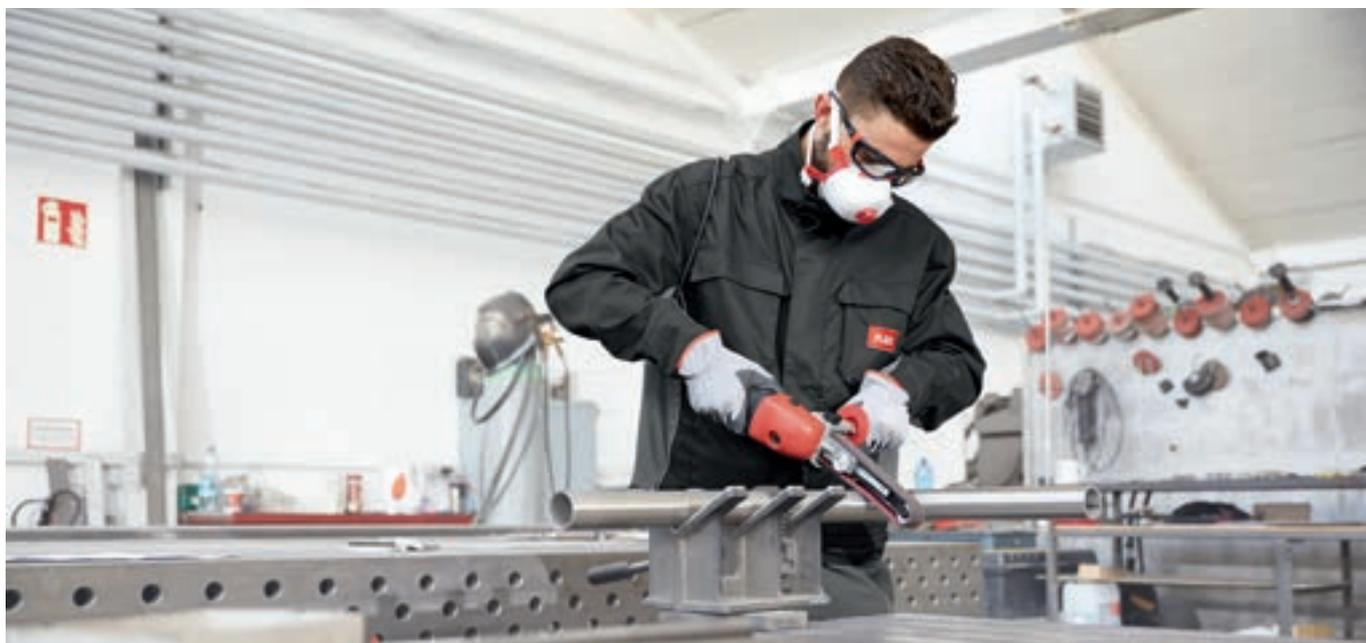
La potente smerigliatrice a nastro FBE 8-140 è ideale per lavori di levigatura, satinatura e sbavatura. Si adatta perfettamente a qualsiasi posizione di lavoro grazie alla testa di levigatura regolabile fino a 270°. La sostituzione del nastro abrasivo e la regolazione della guida del nastro non richiedono attrezzi. Per adattare la velocità della macchina al materiale lavorato, la FBE 8-140 è dotata di preselezione continua della velocità del nastro.
