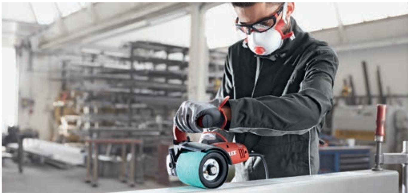
Il potente motore a 1400 Watt, la regolazione variabile e l'accessorio di satinatura fanno della satinatrice TRINOXFLEX la macchina ideale per effettuare lavori di sgrossatura, satinatura, spazzolatura e lucidatura a specchio. La triplice protezione degli avvolgimenti protegge la macchina dalle polveri metalliche assicurando, così, una maggiore durata.
