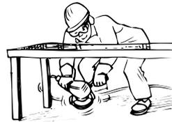
Provate il funzionamento di ogni mola nuova in una posizione sicura per 30 secondi.
