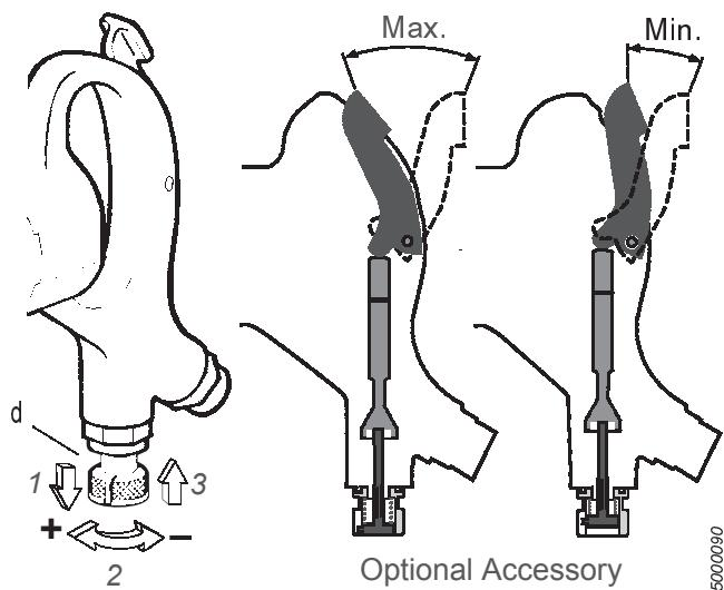
In caso di necessità, si può ridurre la potenza di percussione della macchina limitando la corsa del pulsante di accelerazione, vedasi figura.
