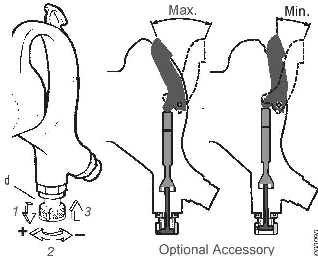
Príklepový výkon stroja môže byť v prípade potreby znížený obmedzením úderu škrtiaceho ventilu, pozrite si obrázok:
