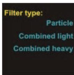
Tipo di filtro in uso. **Se si imposta un tipo di filtro errato, il controllo dell'intasamento non funziona correttamente.**
