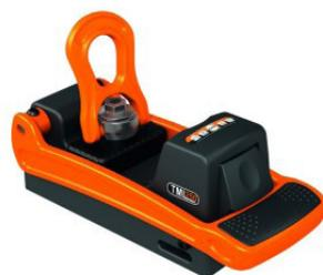
Il sollevatore riesce a sollevare 500 Kg solo se la lamiera ha uno spessore non inferiore a 15 mm e se il carico è posto perfettamente in orizzontale (non vi è nessun grado di inclinazione).
