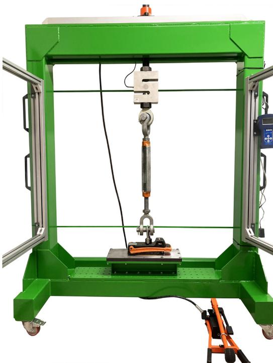
Il laboratorio della BIANCHET S.R.L. si è dotato di una attrezzatura all'avanguardia in grado di effettuare tutti i test di carico del sollevatore in base agli spessori consentiti e osservando i principi della norma **UNI EN 13155:2009**.
