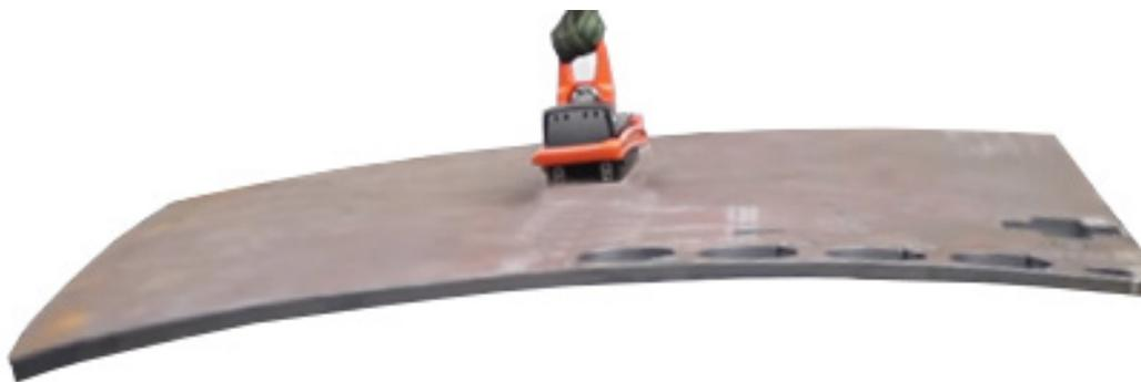
In questo caso non si può utilizzare un solo magnete di sollevamento ma occorre **bilanciare il carico con altri magneti** facendo in modo che vi sia sempre una buona superficie di appoggio per creare l'adeguata potenza magnetica.
