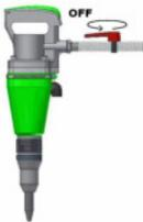
Prima e dopo l'utilizzo del martello, chiudere la presa d'aria della fonte di energia e solo allora rimuovere o collegare il tubo. Prima della messa in funzione, posizionare il martello in posizione verticale.
