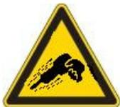
Durante il funzionamento il martello pneumatico produce vibrazioni, che possono causare lesioni a braccia ed articolazioni dovute ad un utilizzo improprio.
