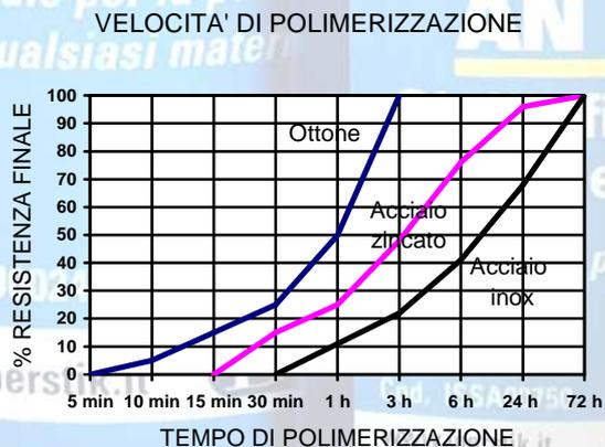
La temperatura ambientale influenza la velocità di reazione. La temperatura ideale di polimerizzazione è compresa tra 20°C e i 25°C. Temperature comprese tra i 5°C e i 20°C rallentano la reazione, temperature superiori la velocizzano.
