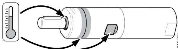
I seguenti punti caldi sul motore (come si vede nella figura in alto) possono raggiungere temperature elevate durante il funzionamento:
